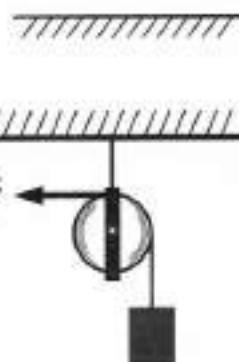
**9** Груз удерживают в равновесии с помощью блока, изображённого на рисунке, действуя силой  $F = 5 \text{ Н}$ . Чему равен вес груза?
